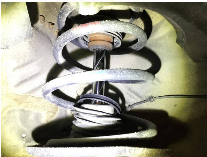
3.1 Støvmansjetter, morkne. Dempere er ok.
