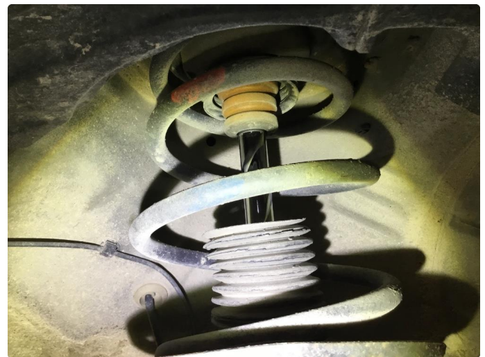
3.1 Støvmansjetter, morkne. Dempere er ok.
