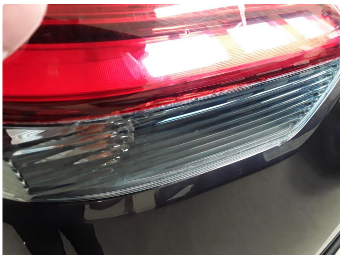
1.1 Liten sprekk i baklykt
