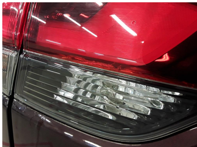
1.1 Liten sprekk i baklykt
